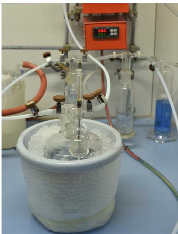
Abbildung 2: Apparatur zur Herstellung der Ozonlösung (Starkwasser) im Labormassstab.
